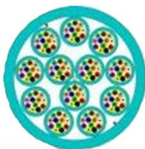
Fig. 5-16. Kabllot optike të vendosura në formë tuba
